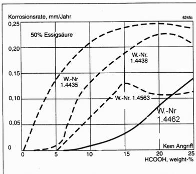
Korrosionsrate von 1.4462 in kochenden Mischungen aus Essigsäure mit wechselnden Anteilen von Ameisensäure
