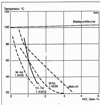
Iso-Korrosionsdiagramm für 1.4462 in Salzsäure
