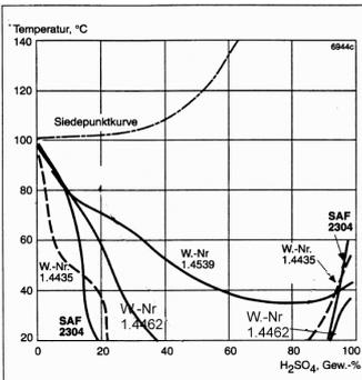
Iso-Korrosionsdiagramm für 1.4462 in Schwefelsäure
